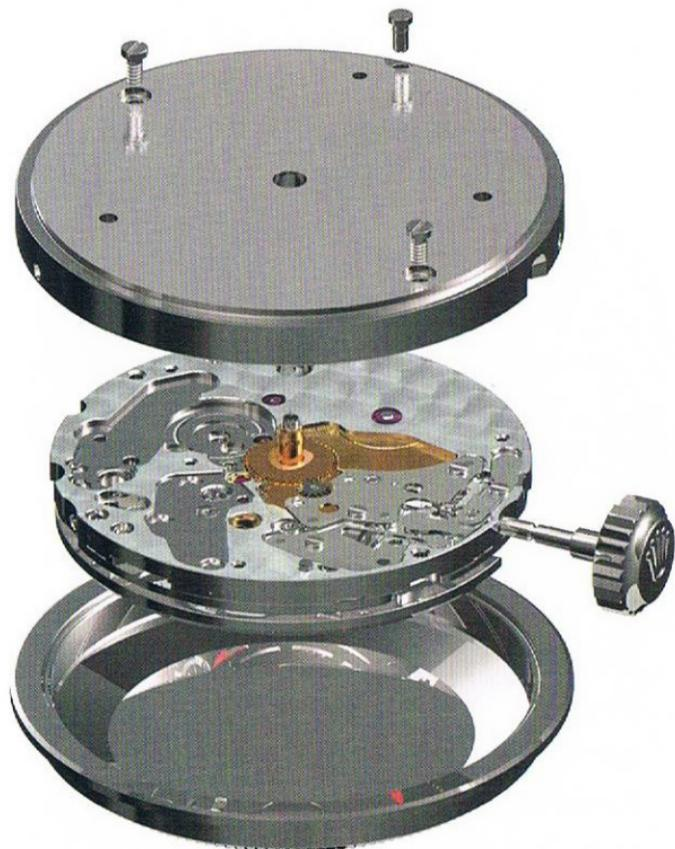
Das Automatikwerk der Milgauss, das Kaliber 3131, ist mit einer blauen PARACHROM Breguetspirale mit Endkurve ausgerüstet, die um mehr als das Zehnfache widerstandsfähiger gegen Erschütterungen und unempfindlicher gegenüber Magnetfeldern ist. Um das Funktionieren der Hemmung zu optimieren, wurde von Rolex ein neues synthetisches Schmiermittel entwickelt. Zudem ist sie mit einem Hemmungsrade aus einem neuartigen paramagnetischen Material ausgestattet.
